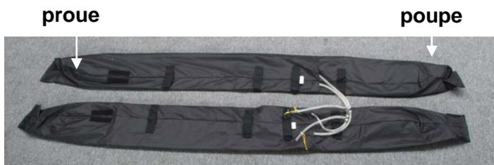
Dépliez les 2 éléments gonflables. Ces éléments (2 boudins) sont reliés ensemble un peu au-delà du centre miteinander verbunden. Ces tubes de liaison servent à équilibrer la pression. Les tubes flexibles de remplissage sont situés derrière le cockpit. Les **bandes de scratch** sont du côté **avant**.
