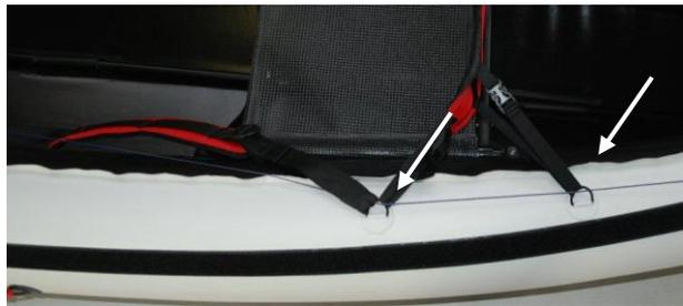
Faites passer alors les deux cordes de direction depuis l'arrière vers l'avant à travers les oeilletons auxquels sont également attachées les sangles du siège.
