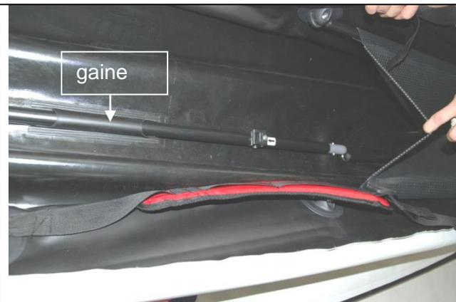
L'illustration ci-contre montre le longeron de quille avec un clip mais sans demi-tube riveté, quand il est clipsé au longeron arrière installé précédemment.
