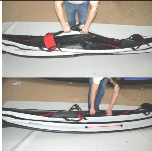
Repoussez ensuite les longerons avec précaution vers le bas jusqu'à ce ceux-ci se retrouvent l'un sur l'autre sur le plancher du bateau. On obtient une bonne rigidité dans toute la longueur, l'ossature tendant bien la toile.
