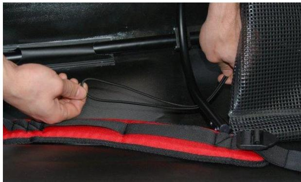
Faites passer les rallonges de corde de direction (avec la chaîne) depuis l'arrière sous le couple le plus en avant (le couple situé devant le siège avant).
