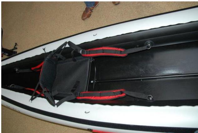
Si vous voulez pagayer en solo dans votre scubi 2, il suffit de s'installer sur le siège avant et de naviguer en sens inverse.
