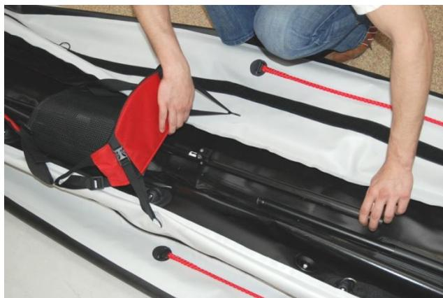
Il ne reste plus qu'un longeron avec clip et demi-tube riveté. Clipsez celui-ci au longeron de quille avant qui a été installé précédemment.
