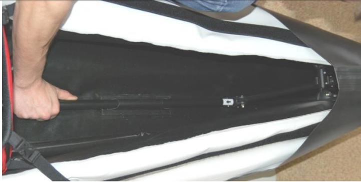
Faites glisser l'ensemble jusqu'au fond de la poupe tout en veillant à ce que les éléments soient bien centrés.
