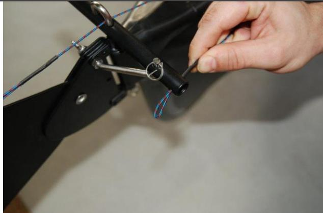
Insérez alors les deux cordes de direction respectivement dans les deux trous à l'extrémité du tube horizontal du gouvernail.
