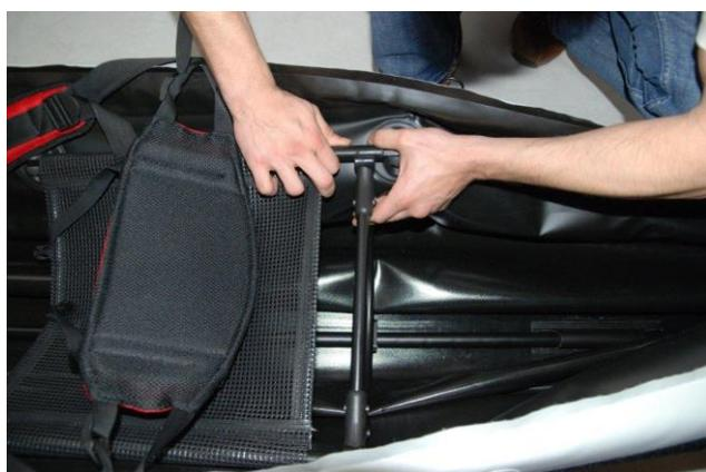
Prenez ensuite les deux couples restant (n° 5 dans l'aperçu du matériel fourni). Placez à nouveau le couple fermé en biais derrière le siège arrière en l'insérant dans le clip de la quille, puis redressez-le à la verticale. Là encore, clipsez les deux encoches des côtés aux barres du siège.
